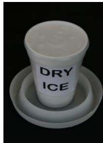
FIG. 2. Interceptor de insectos Climbup® con un vaso tapado conteniendo hielo seco
